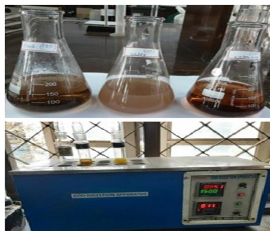
Fig. 6. COD titration, COD digestion apparatus
